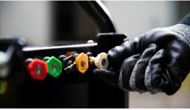
Abb. 14: Hochdruckdüsen für Lanze
