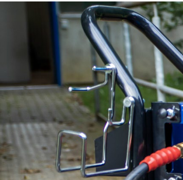
Abb. 15: Aufhänger zur Ablage für die Lanze
