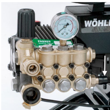
Abb. 18: Überdruckventil mit Pfeil markiert
