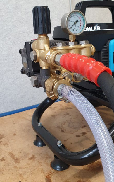
Abb. 17: Transparenter Wasserschlauch angeschlossen
